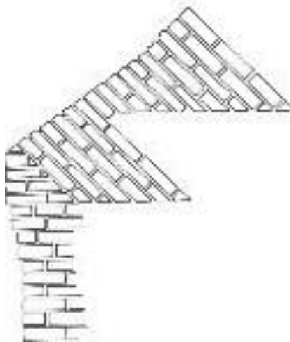
Rampant de toit avec appareillage en épi renforçant la cohésion des briques
